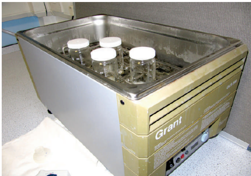
図3. Grant® OLS 200振とう恒温槽内で、37 °Cにて試料を旋回運動により混合している様子を示す写真
