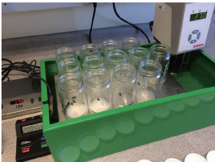
図4. カスタムメイドの恒温槽内に設置された2mag Mixdrive 15® 水中マグネチックスターラーを示す写真。これにより、15検体を速度170 rpm、37 °Cで攪拌できる。
