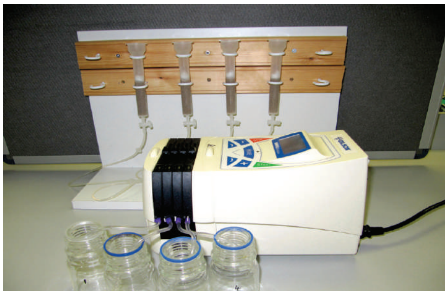
図7. Gilson Minipuls® Evolutionポンプに接続したBio-Rad Econo-Pac® ディスポーザブルクロマトグラフィーカラム〔混合イオン交換樹脂：約4 g Amberlite® FPA53 (OH - ) および約4 g Ambersep® 200 (OH + )〕を用いた試料の脱イオン化。
