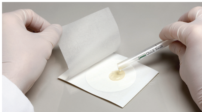
Inoculação da placa de Petrifilm usando o Quick Swab
