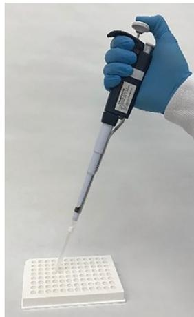
**Image 19.** Distribution de l'échantillon à la pipette dans le fond des puits
