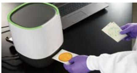
検体名 ID の入力、プレートの種類と希釈倍率の選択をパソコン上で行います。プレートを挿入することで自動でコロニーをカウントします。
